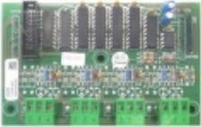
Modulo di espansione per centrale STPL4PLUS da 4 ingressi e 16 uscite open collector.
