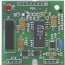
Modulo ampliamento per ulteriori 2 uscite seriali della centrale STMTS/S1 versioni 16, 32, 64.
