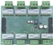
Scheda a 8 relè per modulo STG/OUT16-S. Possibilità di installazione di massimo 2 schede per modulo. La scheda è in grado di trasformare le uscite open collector in uscite a contatti liberi da tensione
